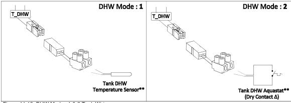
Figure 11.12: DHW Modes 1 & 2 Tank Wiring
